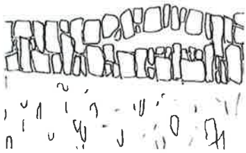
Désolidarisation du parement extérieur par un défaut d'origine, insuffisance de pierres positionnées en boutisse (manque de chevauchement des pierres pour assurer les liaisons internes), la déformation va évoluer lentement jusqu'à l'éboulement.
