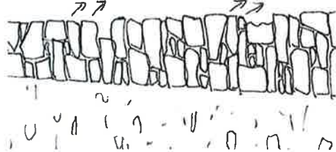
Chute de pierre Les pierres au-dessus perdent leurs appuis, entraînant une chute progressive vers le haut et de plus en plus large.
